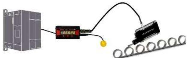
Salida a PLC via CC o Modbus
